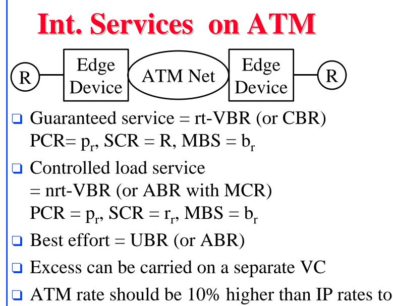
account for 5 byte header/48 byte payload
