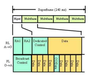
Fig. 2. L-DACS1 physical layer framing
